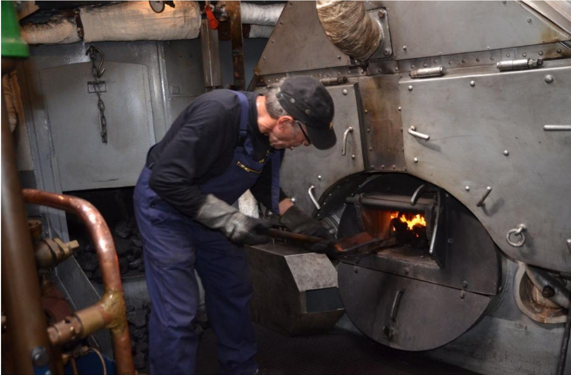
Der Kessel vom Dampfschlepper Woltman braucht etwa 150 kg in der Stunde; der Dampfschlepper Tiger etwa 75 kg, die Dampfbarkasse Otto Lauffer etwa 50 kg. Über die Kessel des Dampfisbrechers Stettin wollen wir hier lieber nicht sprechen.
