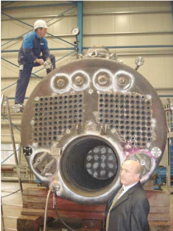
Dipl. Ing. Wolfgang Hoffmeister bei der Druckprobe des TÜVs vor „seinem“ Kessel mit der Baunummer 001.
