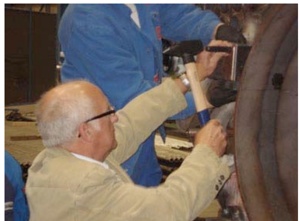
CLAUS D. Obmann Hans J. Stang beim Stempeln des TÜV-Siegels auf die Kesselschildnieten
